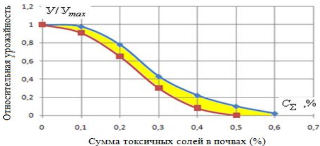
Сурет 4 – Әртүрлі ауылшаруашылық дақылдарының салыстырмалы өнімділігінің топырақтағы уытты тұздардың жынтығына байланысы \bar{y} = y_i / y_{max} = C / C_{\Sigma}
